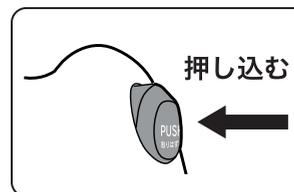
スピード切替スイッチを「0」の位置にし、図のように強く押し込めば外れます。
